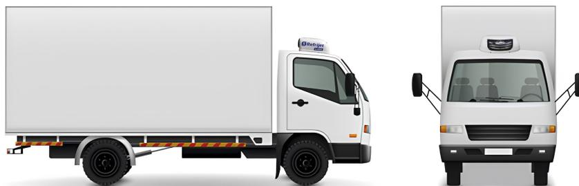
**100% ELÉTRICO**—Utiliza um compressor elétrico 12/24 V ligado a bateria do veículo, podendo ser utilizado com o motor desligado.
